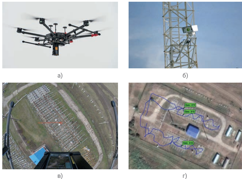
Рис. 1. Использование лазерных детекторов метана с видеокамерой: а) беспилотный летательный аппарат с лазерным детектором и видеокамерой; б) стационарный лазерный детектор метана ДЛС-КС; в) видеоизображение, получаемое с беспилотного летательного аппарата; г) видеоизображение, получаемое с ДЛС-КС
