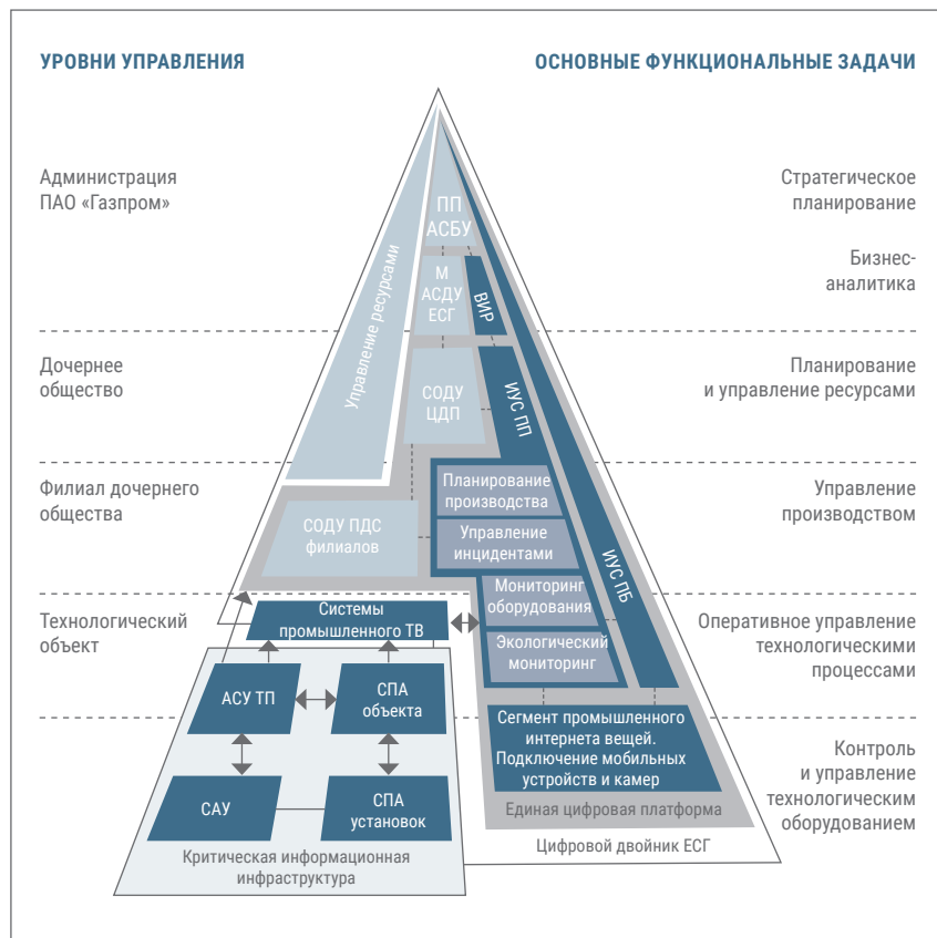
Рис. 4. Использование технологий компьютерного зрения в рамках целевой архитектуры управления производством для решения задач обеспечения производственной безопасности: ВИР – вертикально интегрированные решения; ESG – Единая система газоснабжения; ИУС ПБ – информационно-управляющая система промышленной безопасности; ИУС ПП – информационно-управляющие системы производственных процессов; М АСДУ ESG – модернизированная автоматизированная система диспетчерского управления Единой системой газоснабжения; ПДС – производственные диспетчерские службы; ПП АСБУ – планирование производства в автоматизированной системе бухгалтерского учета; СОДУ – системы оперативного диспетчерского управления; СПА – системы пожарной автоматики; ТВ – телевидение; ЦДП – центральные диспетчерские пункты
