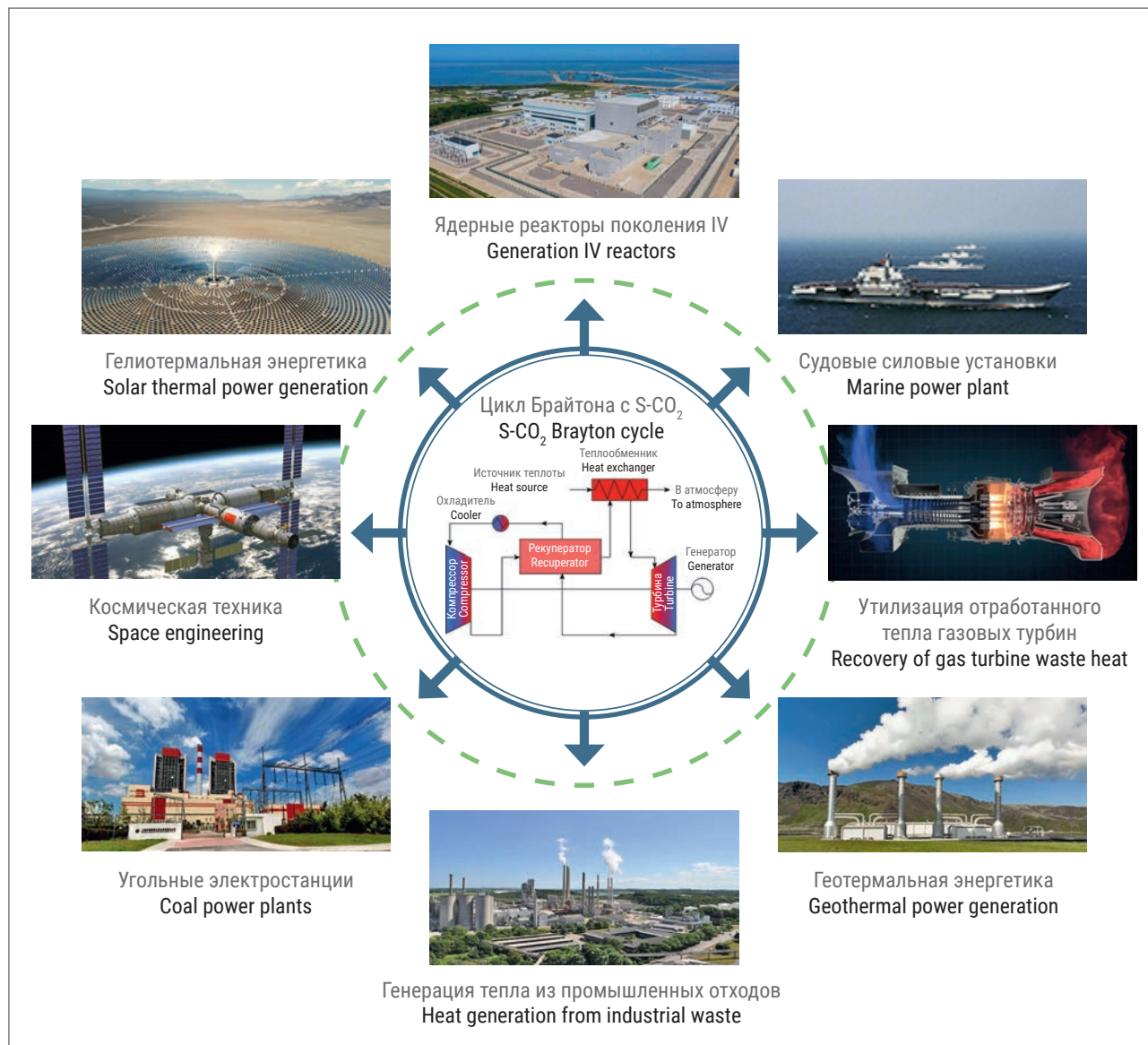
Рис. 5. Потенциальные области применения цикла Брайтона с S-CO 2 Fig. 5. Potential uses of S-CO 2 Brayton cycle
