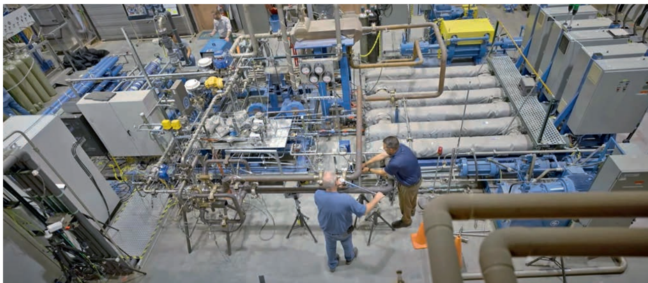
Рис. 10. Стенд сверхкритического цикла Брайтона на CO 2 Сандийских национальных лабораторий [21] Fig. 10. S-CO 2 Brayton cycle bench of Sandia National Laboratories [21]
